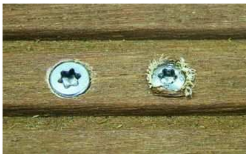
Abb. 6: Links Zylinderkopf der „EASYpat“, rechts konventioneller Senkkopf
