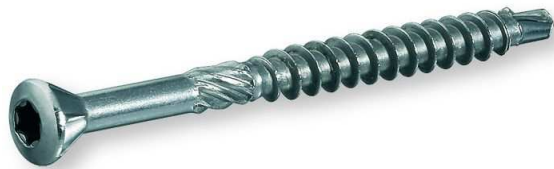
Easytop Schraube aus martensitischem Edelstahl mit Bohrspitze, Senkfräskopf und Reibeschaft
