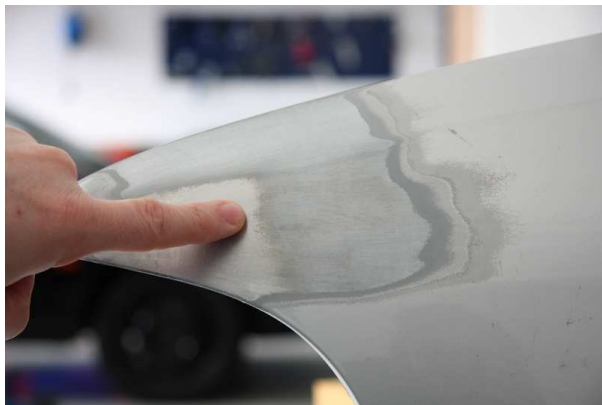
Fertig verzinktes Karosseriestahlblech – links (sh. Finger) ist die blanke, unbearbeitete Stelle. Die rechte Stelle wurde durch das Berner Re-Zinc mit einer Zinkschicht versehen.
