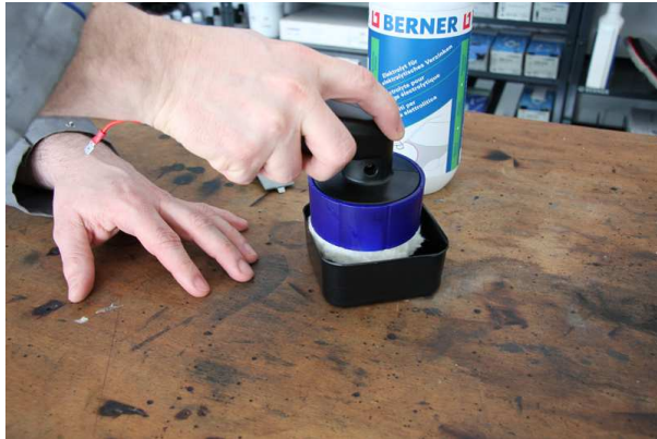
Das Pad wird vor der Anwendung in Elektrolyt getränkt
